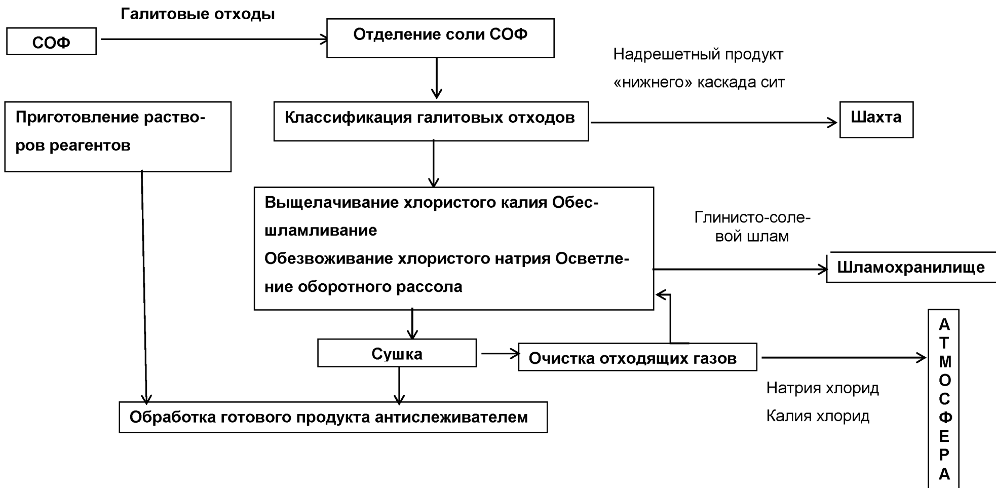
Рисунок 9.1— Принципиальная схема производства соли Камской поваренной, концентрата минерального «Галит» марки «А», концентрата минерального «Галит» (состав ПГМ)
